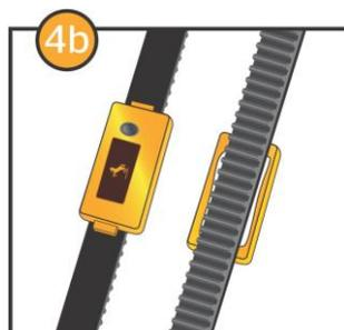
Закрепите VSM Mini на задней части ремня с помощью клейкой массы. VSM Mini также можно повернуть на 90°, а затем установить
