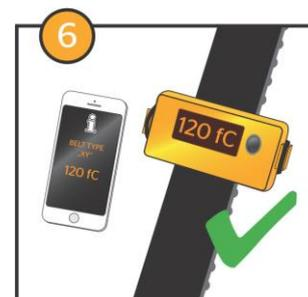
Если частота, показываемая прибором, соответствует правильной частоте Conti, датчик можно снять. Если она отличается, увеличьте или уменьшите натяжение
