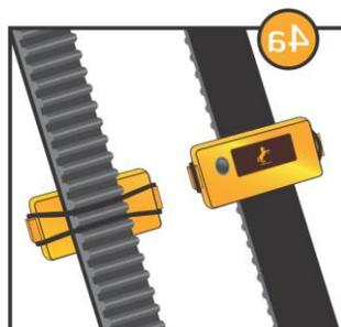
Установите VSM MINI на задней части ремня с помощью резинового кольца. VSM MINI должен быть установлен в средней точке межосевого расстояния
